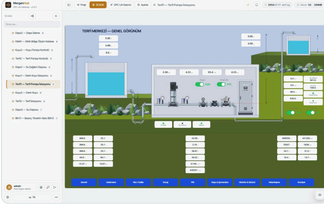
Terfi merkezi: pompa durumları, debi, basınç, enerji
