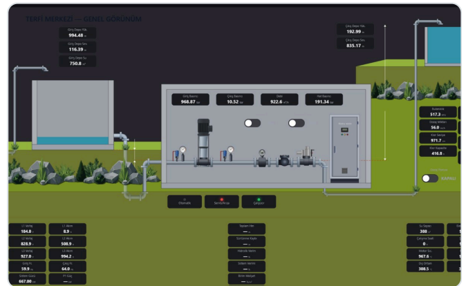
Terfi merkezi: pompa grubu, hazne seviyeleri, basınç
